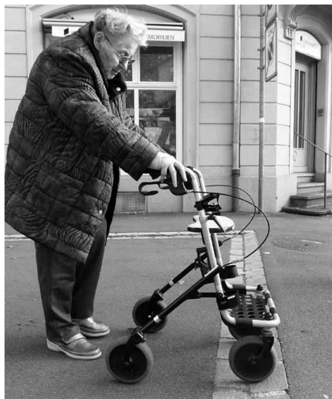
Studie: Befahrbarkeit niedriger Randabschlüsse mit Rollator, Zürich Wildbachstrasse Foto: Fachstelle
