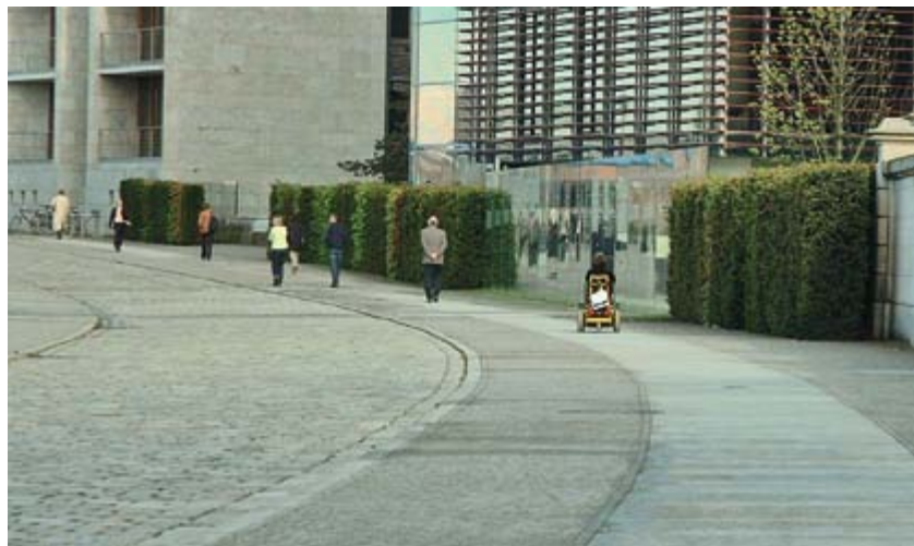
3: Ein Plattenbelag gewährleistet eine erschütterungsfreie Fahrt, markiert den Zirkulationsbereich und unterstützt die Orientierung. (Bild: Berlin)
