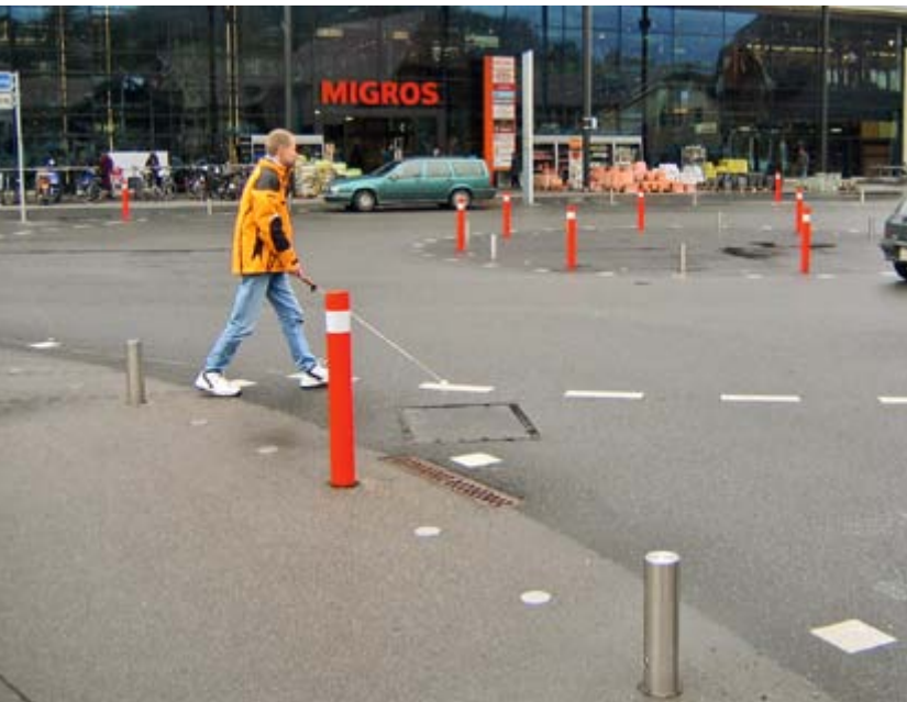
7: Der Fahrbahnrand ist nicht erstastbar. Im Kreiseln fahrende Fahrzeuge können akustisch nicht einer Fahrbahn zugeordnet werden. (Köniz, Bläuackerplatz)
