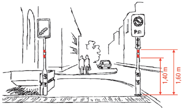
Markierung freistehender Hindernisse vorzugsweise 1,40 m - 1,60 m über Boden
