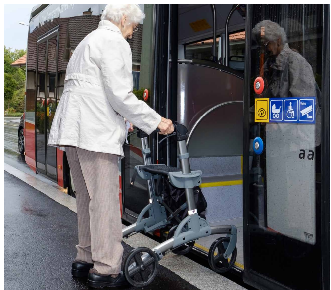
Hohe Haltekanten ermöglichen den autonomen Einstieg
