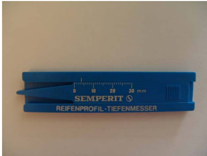
Abbildung 16: Schieblehre für Profiltiefe und Verschleissring-Breite
