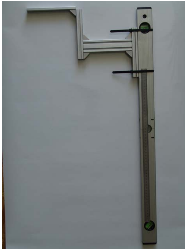
Abbildung 12: Schieblehre für Reifenhöhe
