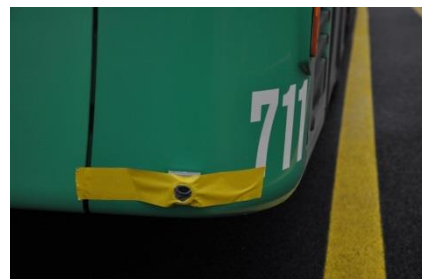
Abb. 18 Reflektor (passiv) an Busheck
