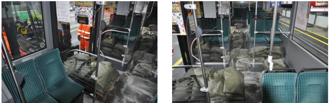
Abb. 19 Busbeladung mit Sandsäcke
