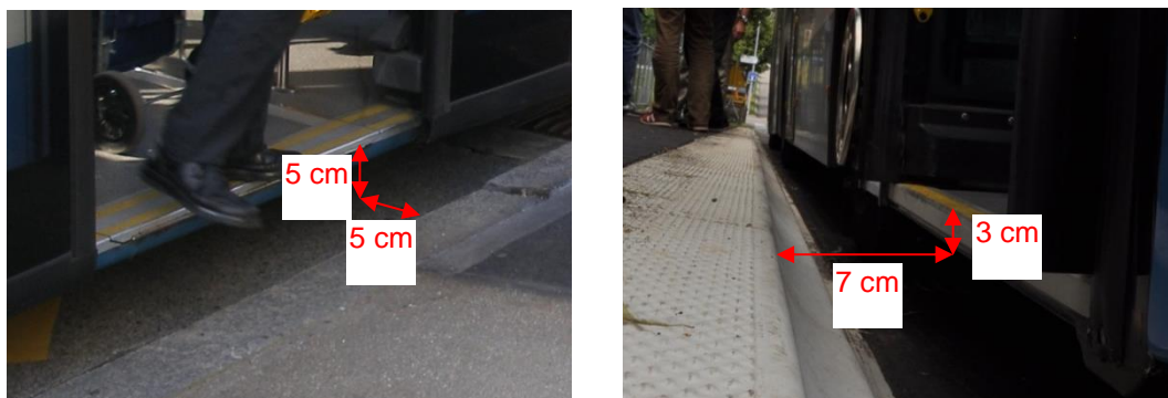
Abb. 1 max. zulässige Spaltbreite/Spalthöhe
