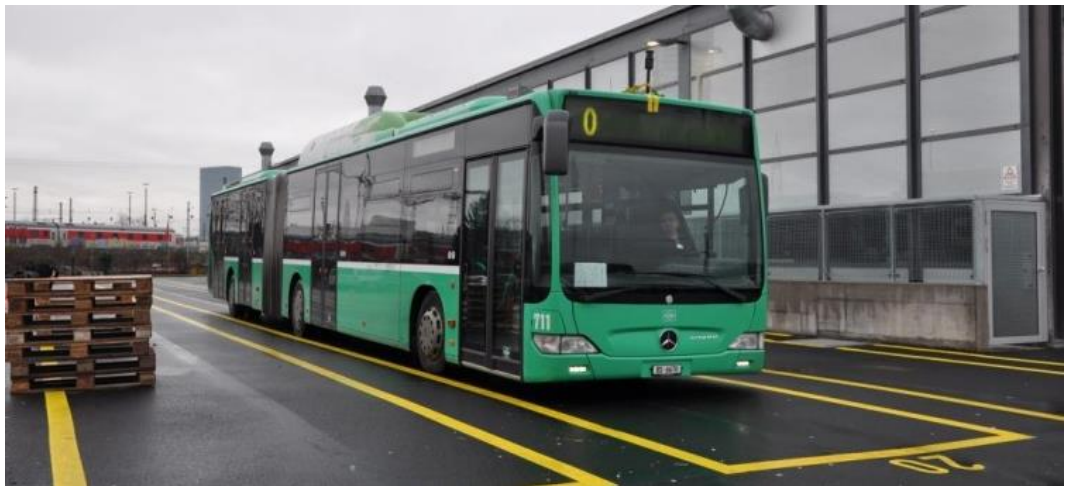
Abb. 20 Einfederung Busfront v_E \sim 17\text{cm} bei einer Notfallbremsung aus 5\text{km/h}
