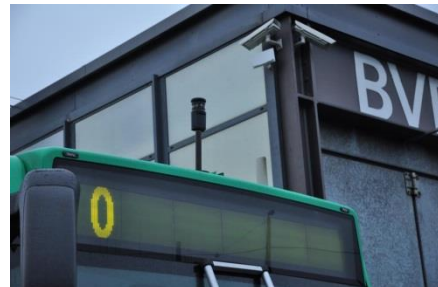
Abb. 17 Reflektor (aktiv) auf Busdach
