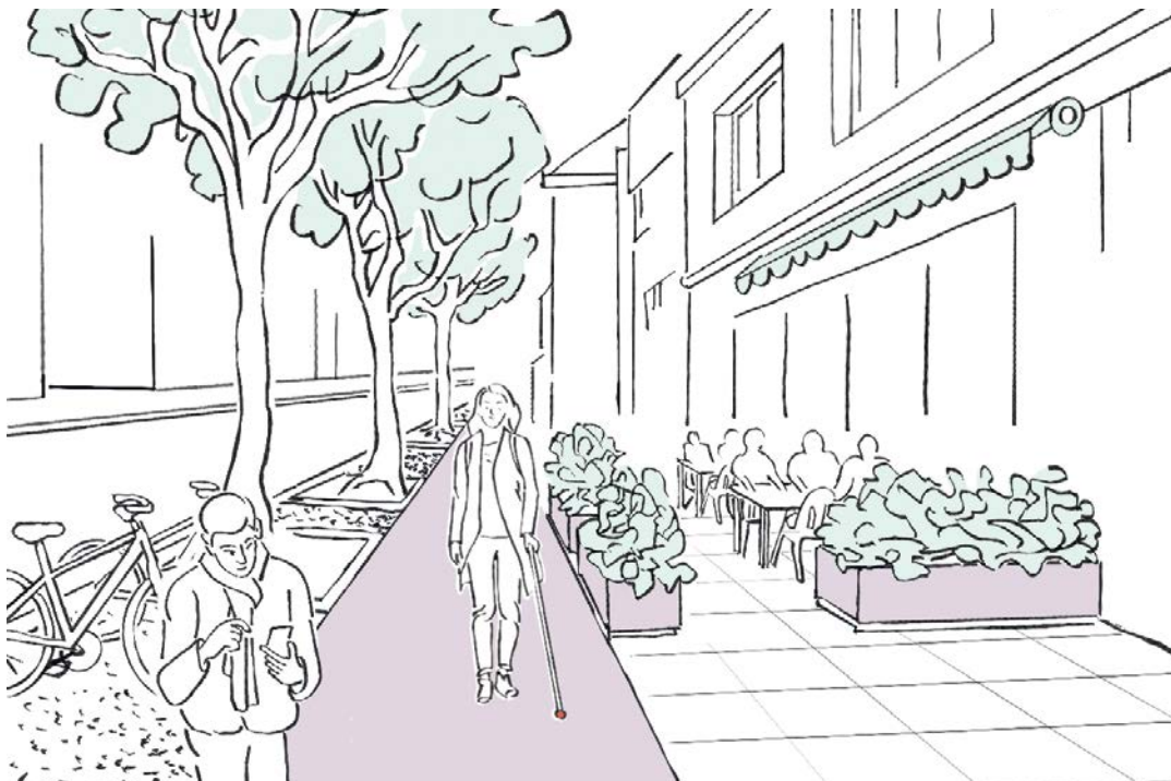
Abb. 14 Hindernisfreie Wege vereinfachen die Orientierung und sorgen für Sicherheit, insbesondere für Menschen mit Sehbehinderung.
