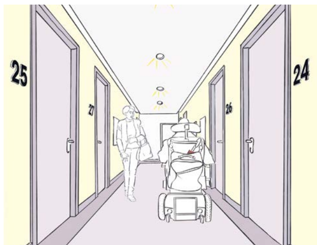
Abb. 21 Kontrastreiche Türen mit ausreichenden Manövrierflächen und geeignetem Türgriff.
